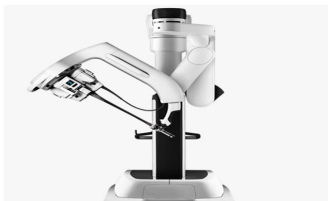
Figura 6. Dispositivo da Vinci SP (Single-Port).
